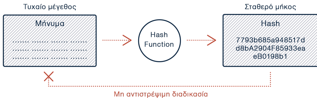
Σχήμα 2.1: Λειτουργία συνάρτησης κατακερματισμού
