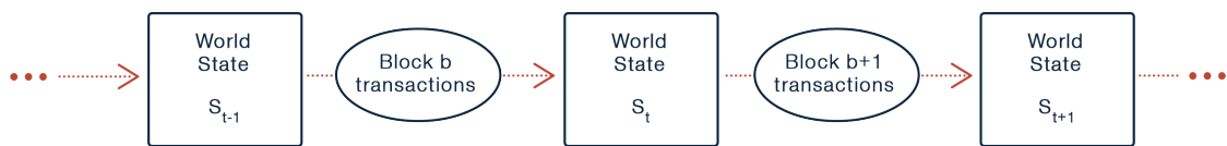
Σχήμα 2.8: Blockchain ως μηχανή καταστάσεων
